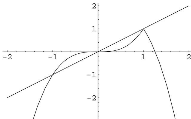
L'equazione  $x = g(x)$  ha tre soluzioni  $\alpha = -1$ ,  $\beta = 0$  e  $\gamma = 1$ , le prime due di molteplicità 1. Per la terza soluzione non si può definire la molteplicità in quanto il rapporto  $|f(x)|/|x - 1|$  non ha limite per  $x \rightarrow 1$ .
