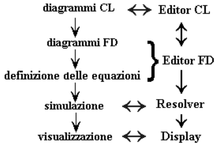
Figura 3.2: Relazioni logiche fra operazioni e moduli dell'ambiente D(a)ySy Tool Box
